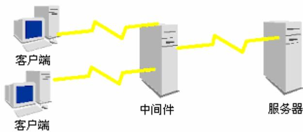
图 1: 采用中间件的构架示例
